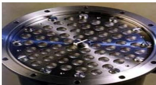
Différents canaux tubulaires montés en parallèle dans un même support (barreau).
