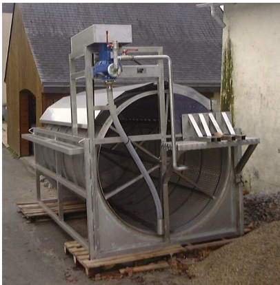
Filtre à tambour rotatif – photo : RB
