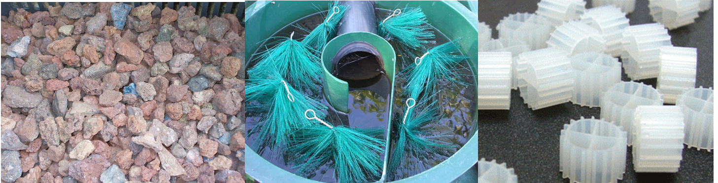
Médias de biofiltre: pouzzolane et brosses – Photos : Rémi Bertran
